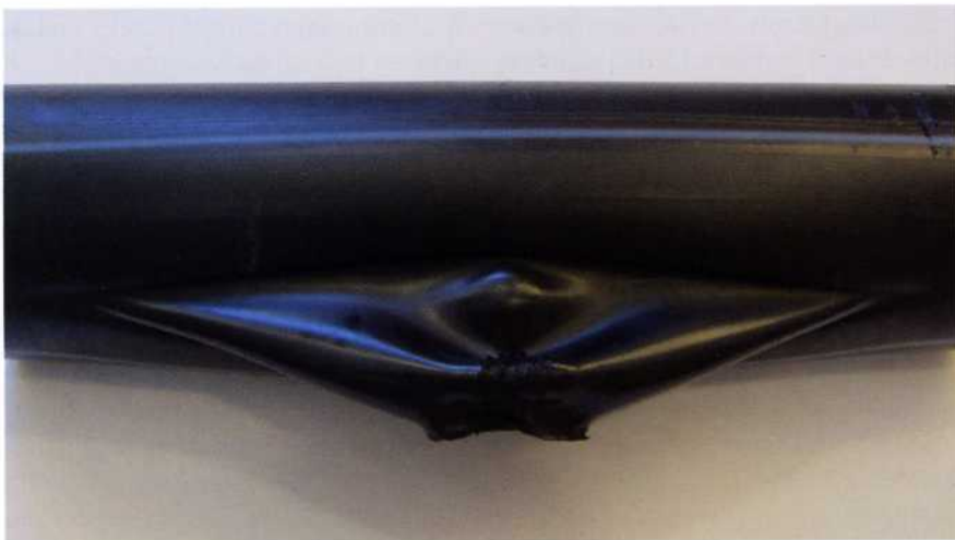
Frostskade på rør. Det har fryst på begge sider, og så har trykket inne i røret økt så kraftig at den har blåst ut et hull på røret. Foto: Aslaug Koksvik
